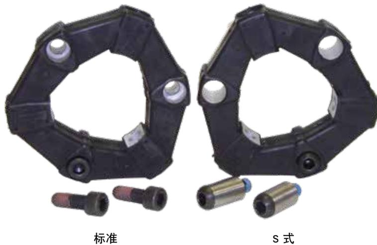
洛夫乔伊的 LF 产品系列支持标准样式元件（左上）和 S 式元件（右上）。标准式元件栓接到圆柱形（中心）轮毂以及飞轮、飞轮转接板或法兰轮毂。S 式元件使用的螺栓看上去与定位销相似，设计用于“盲式”安装，在安装过程中可能无法接触到轴向螺栓以进行紧固。有一种应用是在钟形罩内部，此时所有组件都已组装好，且无法接触到螺栓。S 式螺栓在必要时还可承受少量轴端浮动，以防止元件上产生不必要的轴向应力。当需要更换元件时，请注意轴向孔的差异。标准元件具有阶梯孔，以适应安装元件时所用的帽螺钉（左上）。S 式元件采用直孔（右上）以适应 S 式销。
